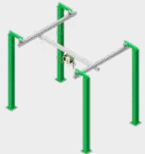
Puente grúa montado en columnas
